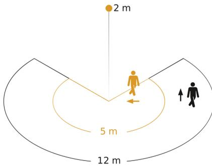
Possibile altezza di montaggio: 1,80 m - 4,00 m
